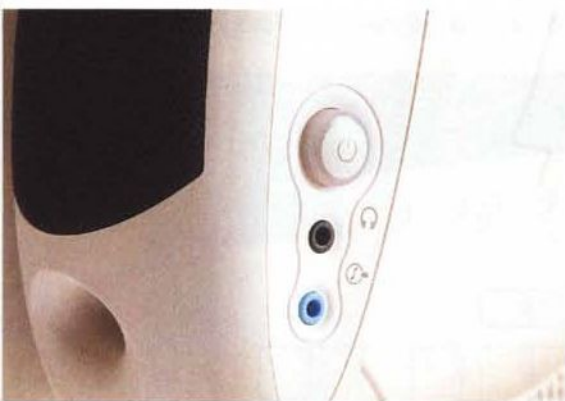
Sull'altoparlante destro sono presenti, il tasto di accensione, una presa di uscita per cuffia, che esclude gli speaker principali, e una presa di ingresso che consente di ascoltare una sorgente ausiliaria
